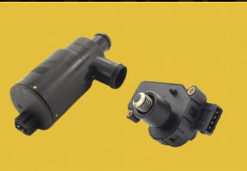
Ein Leerlaufregelventil sorgt dafür, dass der Motor im Leerlauf stabil läuft, indem es die Luftzufuhr reguliert. Es verhindert ein Absterben des Motors bei niedrigen Drehzahlen.
