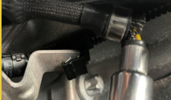
3. Prerušený kabel na hlavě snímače
