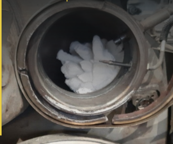
4. Usazování AdBlue při vstřikování pod 180 °C
