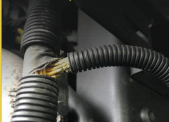
3. Prerušený kabel na hlavě snímače
