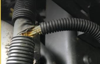
3. Rupture de câble à la tête du capteur
