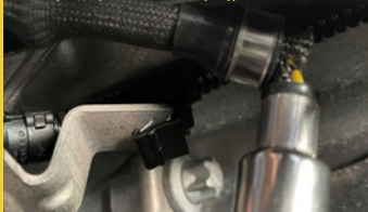
3. Σπασμένο καλώδιο στην κεφαλή του αισθητήρα
