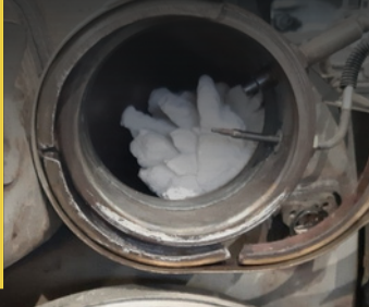
4. Εναπόθεση AdBlue με έγχυση κάτω από 180°C
