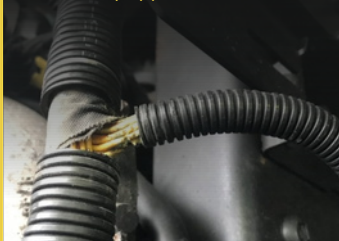
3. Σπασμένο καλώδιο στην κεφαλή του αισθητήρα
