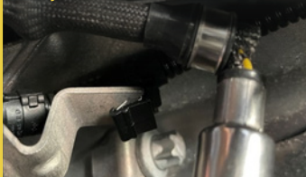
3. Przerwa w kablu na głowicy czujnika
