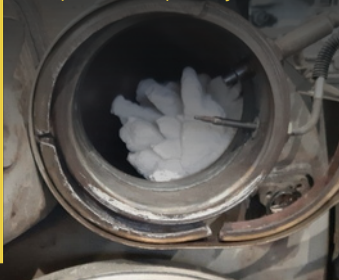
4. Osady z wtrysku AdBlue w temperaturach poniżej 180°C
