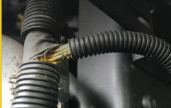
3. Przerwa w kablu na głowicy czujnika
