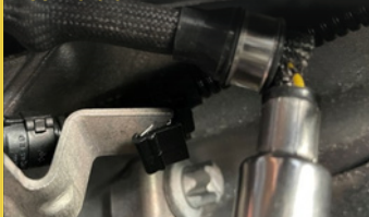
3. ruperea cablului la capul senzorului
