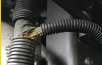
3. ruperea cablului la capul senzorului
