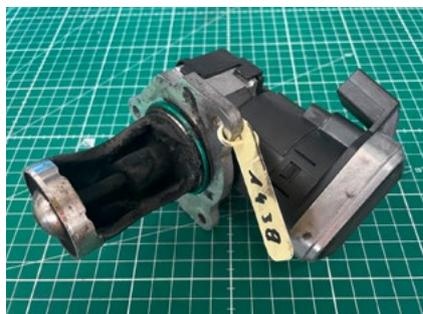
Aufgrund der strengeren Euro6 Norm und eingeschränkten Betriebsbedingungen gehört die **Niederdruck AGR** mittlerweile zur Grundausstattung jedes neuen Fahrzeuges. Bei diesem System wird das Abgas erst hinter dem Partikelfilter entnommen und z.B. vor dem Turbolader rückgeführt. Dies sorgt für gereinigtes rückgeführtes Abgas was einer Versottung des AGR-Kühlers verhindert. Aufgrund des niedrigeren Abgasdruckes muss in diesem Fall jedoch eine weitere Ab-
