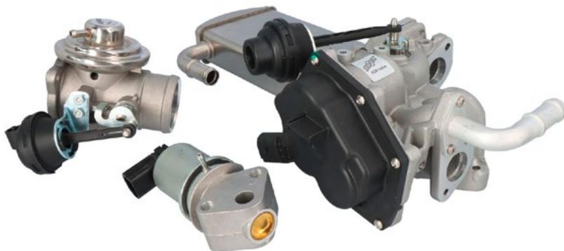
Ursprünglich diente die Abgasrückführung zur Senkung des Kraftstoffverbrauchs bei Benzinmotoren. Heute wird die AGR in der Regel zur Reduzierung der Stickoxide bei Benzin- und Dieselmotoren eingesetzt. Dabei unterscheidet man **zwei Systeme**:
